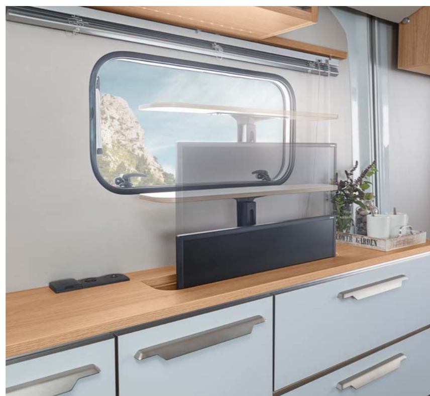
DESEO 400 TR. Nedsænkkeligt LED-TV. For at undgå, at tv'et bliver beskadiget under kørslen og optager så lidt plads som muligt, forsvinder TV'et elegant ned i siden.
